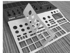
**Achtung:** Die Klebestreifen (für die temporäre Fixierung) dürfen sich währenddessen **auf keinen Fall lösen!** Zudem ist darauf zu achten, dass das nun klebende Overlay in diesem Schritt noch **nicht** das Gerät berührt.
